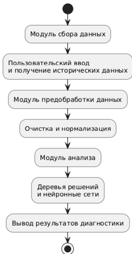
Рис. 1. Блок-схема архитектуры ИИ-модуля диагностики
