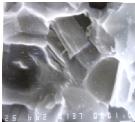
Рис. 12. Хрупкое разрушение карбидных зерен в сплаве 70 % TiC – сталь X14Г10Т6, увеличение \times 6600
