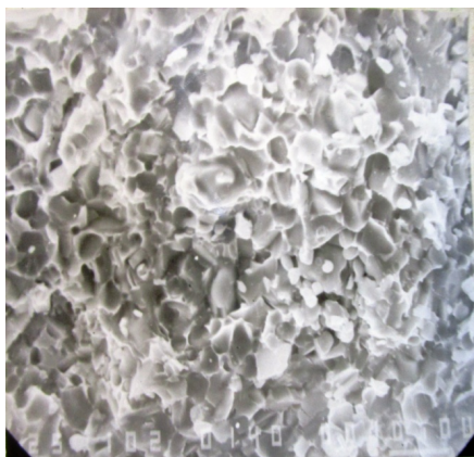
Рис. 11. Микрорельеф излома сплава 70 % TiC – сталь X14Г10Т6, увеличение \times 1000
