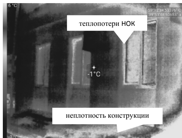
Рис. 2. Фотография наружной стены здания и ее термограмма.
