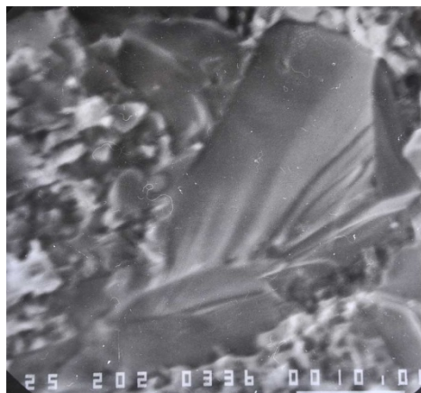
Рис. 7. Микрорельеф излома сплава 70 % WC – Fe, ×2000
