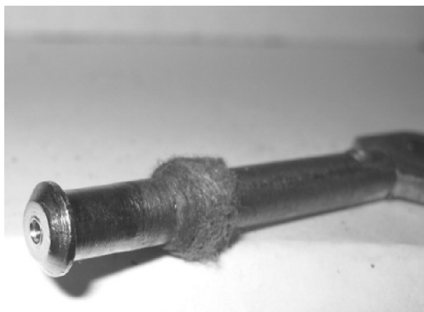
Рис. 4. Шип типа 8-10-1, установленный на шток
