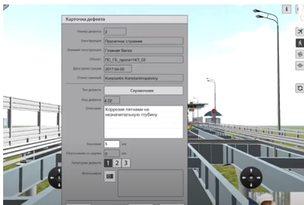
Рис. 2. Описание дефекта в BIM-модели
