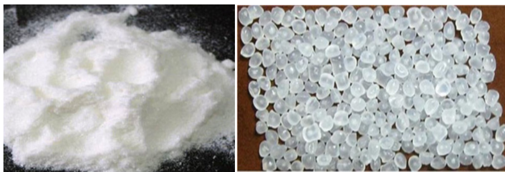
Рис. 2. Полипропилен: а) порошкообразный, б) в гранулах
