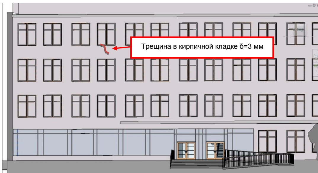
Рис. 1. Пример оформления информации о дефектах на фасаде здания
