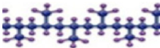
Рис. 6. Синдиотактическая структура молекул полипропилена
