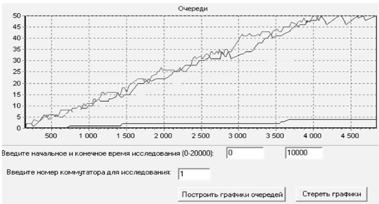
Рис. 4. Результаты моделирования изменения размера буферного накопителя в зависимости от числа тактов функционирования сети на режиме взвешенного справедливого обслуживания
