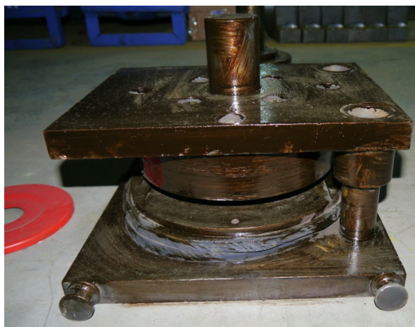
Рис. 8. Фото изготовленного штампа и изделия «Крышка»
