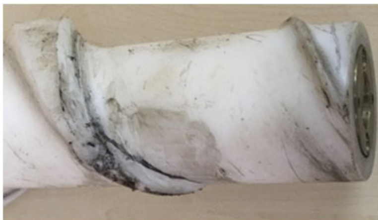
Рис. 2. Следы эксплуатационного износа в захватной зоне
