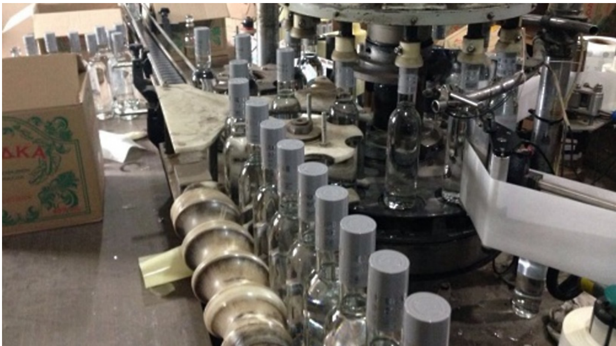
Рис. 10. Перемещение тары валом с винтовой линией с переменным шагом
