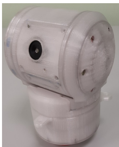
Рис. 1. Общий вид гиростабилизированного опорно-поворотного комплекса технического зрения
