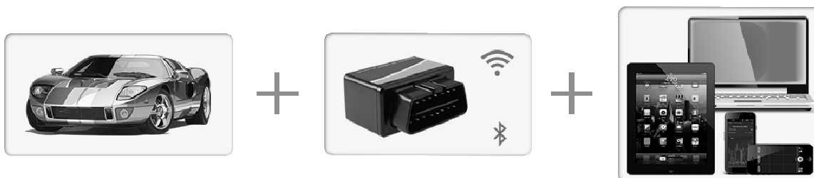
Рис. 1. Подключение адаптера и конечного устройства к диагностическому разъему автомобиля
