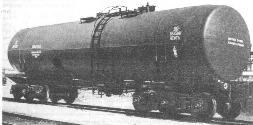
Рис. 3. Нефтеналивная цистерна объемом 60 м 3
