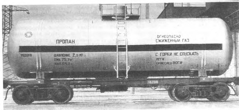
Рис. 2. Цистерна для перевозки сжиженных углеводородных газов (модель 15:1569)
