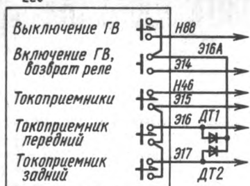
Рис. 2. Измененная схема управления главным выключателем
