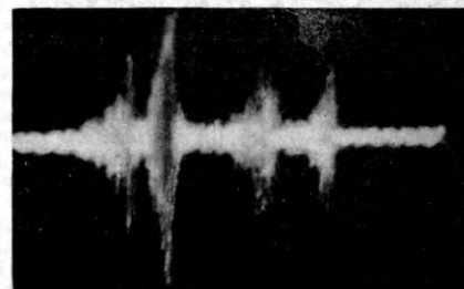
Рис. 2. Осциллограммы виброускорений наружной поверхности нагнетательного трубопровода для неисправной топливной системы (сверху вниз): наличие подвпрыска топлива; зависание иглы форсунки при ее движении; зависание иглы форсунки и наличие подвпрыска
