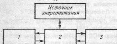
Рис. 1. Блок-схема модульного комплекса: 1 — станция нагрузочных испытаний двигателей; 2 — модуль силовых тиристорных преобразователей; 3 — станция нагрузочных испытаний дизель-генераторных установок
