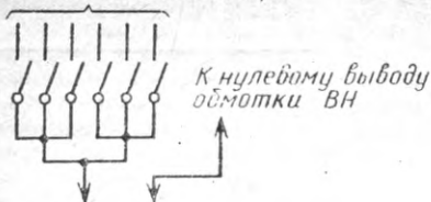
Рис. 5. Схема шести рубильников для подключения омметра
