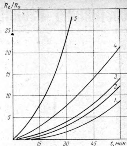
Рис. 3. Зависимости роста величины сопротивления при разных способах сушки: 1 — вентиляторами; 2 — током возбуждения; 3 — калориферами; 4 — от контактной сети; 5 — током возбуждения двигателей НВ-507
