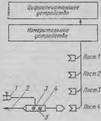
Рис. 1. Блок-схема системы контроля электрических цепей тепловозов серии 2ТЭ10: 1 — базовый зажим; 2 — измерительный контакт; 3 — лампа «Измерение»; 4 — кнопка «Запуск»; 5 — измерительный щуп
