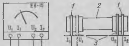
Рис. 1. Простейшее диагностическое устройство: 1 — токовые зажимы; 2 — предохранитель; 3 — измерительные зажимы
