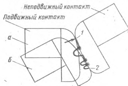
Рис. 3. Траектория движения силовых контактов при включении:
