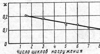
Рис. 2. Зависимость долговечности от исходного разброса характеристик резин
