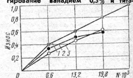
Рис. 2. Зависимость износа втулок из стали 110Г13Л (1) от числа циклов и от легирования ее титаном 0,08% (2) и ванадием 0,3% (3)
