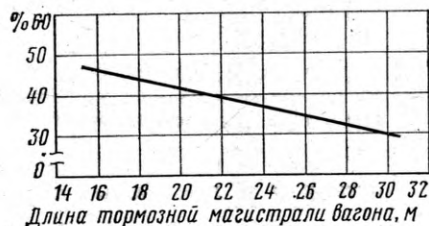
Рис. 8. Сокращение времени наполнения тормозного цилиндра последнего вагона в поезде длиной 2300 м при полном служебном торможении с воздухораспределителями ABDW в зависимости от длины тормозной магистрали каждого вагона поезда. Зарядное давление 5,6 кгс/см 2 , утечка минимальная
