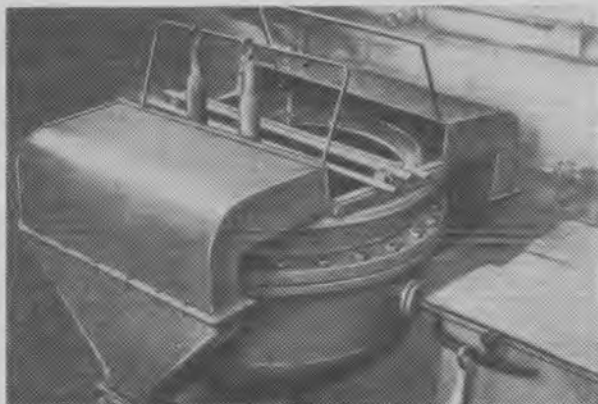
Механизмы и устройства, применяемые при ремонте редукторов электровозов ЭР2 в моторвагонном депо Харьков (сверху вниз): ● кантователь редуктора, в левом углу приспособление для сборки переднего подшипника малой шестерни; ● механическая притирка фланцев упругой муфты; ● ванна осталивания
