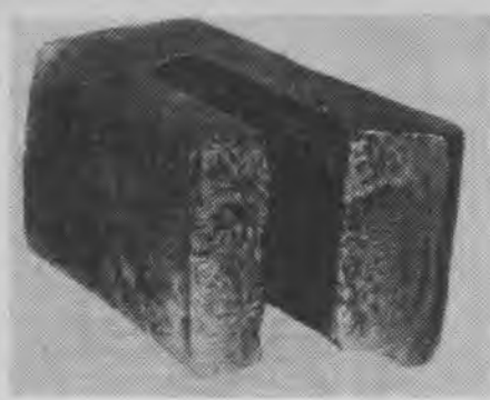
Излом хвостовика корпуса автосцепки по отверстию для клина тягового хомута. На внутренней поверхности излома видны литейные дефекты: термические трещины, осадочные раковины, в остальном сечении хрупкий излом, блестящая поверхность
