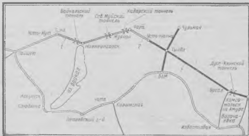
Рис. 4. Схема трассы БАМ с указанием видов тяги: 1 — электрическая тяга; 2 — тепловозная тяга с учетом электрификации в дальнейшем (на первую очередь); 3 — тепловозная тяга с учетом электрификации в дальнейшем (на вторую очередь)
