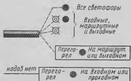
Рис. 1. Показания путевых светофоров, при которых на локомотивном светофоре горит желтый с красным огонь
