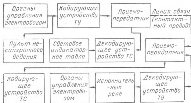
Рис. 2. Структурная схема системы «Братск-1М»
