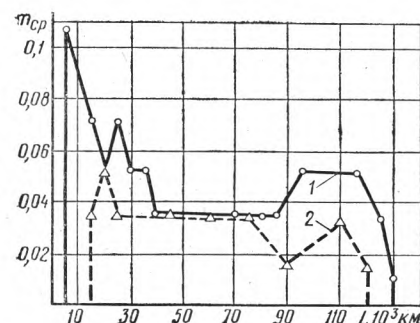
Рис. 3. График изменения среднего числа отказов в зависимости от пробега: 1 — серийные тепловозы; 2 — модернизированные
