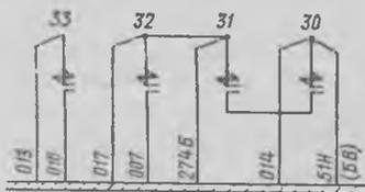
Рис. 7 Монтажная схема группового переключения КСПО
