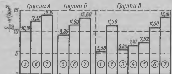
Рис. 2 Изменение удельной прочности соединения вал — шестерня в зависимости от технологии обработки поверхностей:
