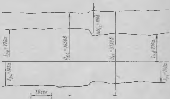
Рис. 3. Осциллограмма кривых якорных токов электровоза ВЛ10 в режиме стабилизации скорости движения: U_{к.с} — напряжение контактной сети; I_{7,8} — ток тяговых двигателей 1-й секции электровоза; I_{7,8} — ток тяговых двигателей 2-й секции электровоза
