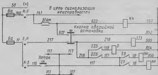
Рис. 5. Схема цепей аварийной остановки дизель-поезда
