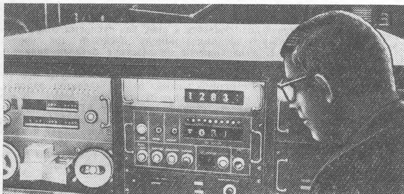
Рис. 1. Прибор «Поиск» для автоматизированных испытаний электрических схем тепловозов
