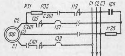
Рис. 2. Схема конденсаторного запуска вспомогательных машин: ФР — фазорасщепитель; P_{31} — P_{33} — пусковые сопротивления; 25 — разрядное сопротивление 2 400 ом; 119, 125 — электромагнитные контакторы; 169 — конденсатор
