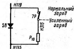
Рис. 3. Схема включения шунтирующего сопротивления на распределительном щите:
