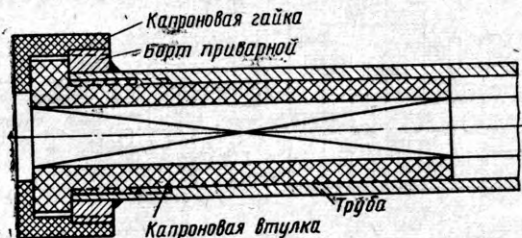
Капроновая втулка телескопического соединения привода скоростемера
