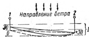
Рис. 1. Вынос контактного провода в зависимости от величины зигзага при направлении ветра, перпендикулярном оси пути:
