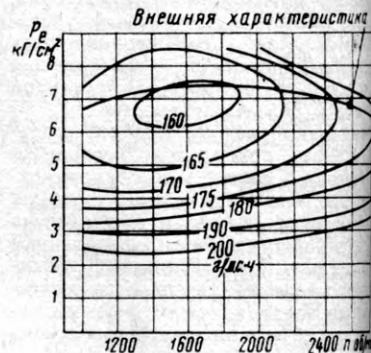
Рис. 4. Диаграмма расхода топлива у двигателей F6L312 с воздушнокамерным процессом сгорания
