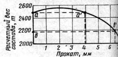
Рис. 2. Зависимость расчетного веса состава от проката для участка А—В
