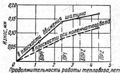
Рис. 1. Износ цилиндрических втулок в зоне верхнего компрессионного кольца
