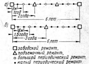
Рис. 3. Система ремонтных циклов тепловозов ТЭМ1
