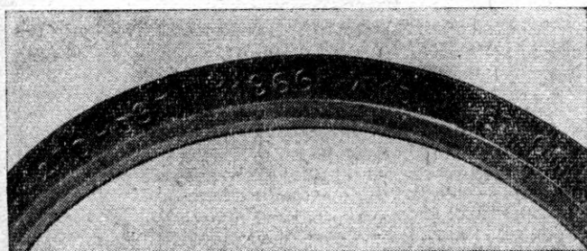
Рис. 2. Маркировка резиновых манжет для тормозных приборов (оттиск от гравировки прессформ). Условные обозначения (слева направо): 270—397 — условный номер манжеты; 1966 — обозначение года изготовления манжеты; к — товарный знак завода; 67 и 68 — обозначения года изготовления манжеты; так как последняя дата «68», то манжета изготовлена в 1968 г.
