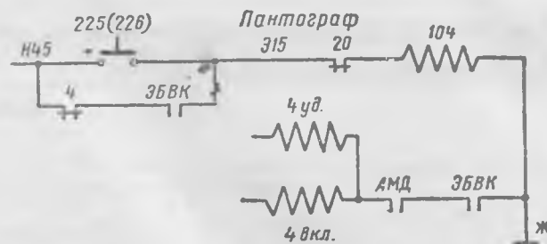
Схема включения контактов ЭБВК на электровазах ВЛ60 с главным выключателем типа ВОВ-25-4.
