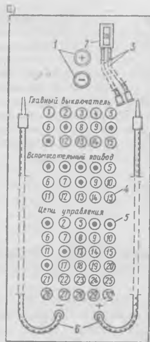
Рис. 1. Схема цепи управления ГВ электровоза ЧС4. Кружками с цифрами обозначены места выводов к панели «Блок обнаружения неисправностей»
