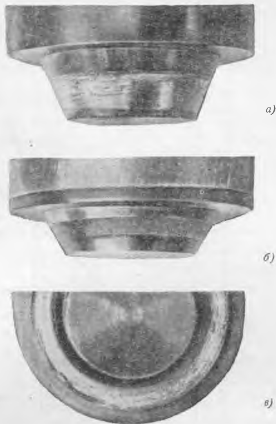
Рис. 6. Состояние уплотнительных поверхностей клапанов из стали ЭЯ2 после испытания. а — уплотнение под углом 40°; б — уплотнение под углом 60°; в — плоское уплотнение.
