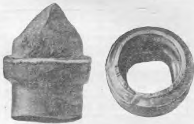
Рис. 1. Клапан и седло с эродированными поверхностями.
