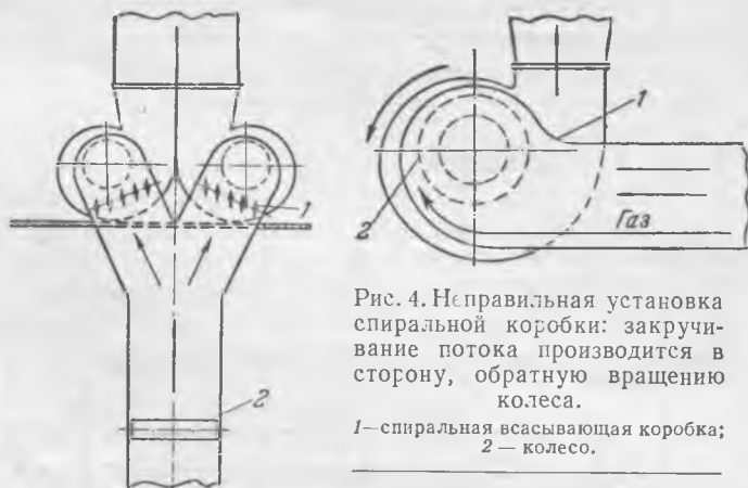
Рис. 3. Дымосос типа ЦВ-32 с направляющим аппаратом упрощенного типа 1 и временно установленным дросселем 2.
