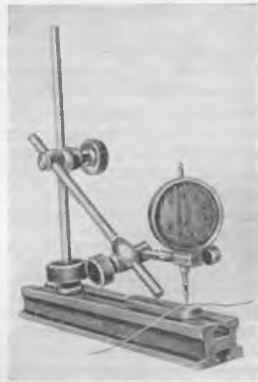
Рис. 4. Установка указателя для проверки свинцовых оттисков.
