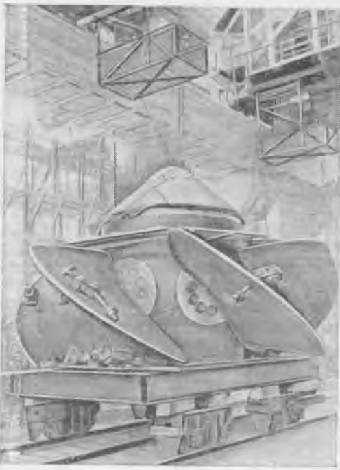
Рис. 4. Собранное рабочее колесо турбины в машинном зале.
