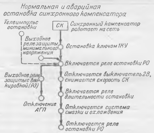
Рис. 3. Диаграммы последовательности операций при пуске и остановке синхронного компенсатора.
