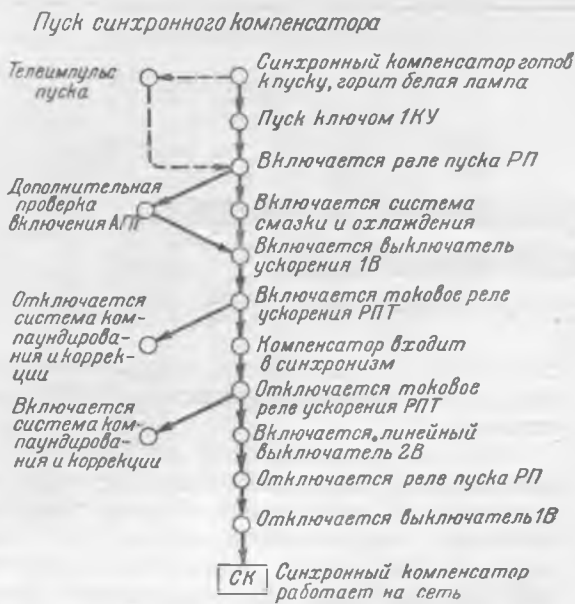
Рис. 3. Диаграммы последовательности операций при пуске и остановке синхронного компенсатора.
