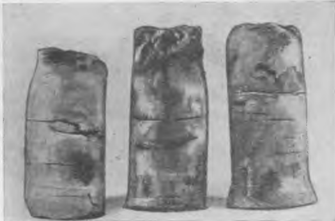
Рис. 7. Кольцевые трещины в питательных трубах котлов 64 ати.
