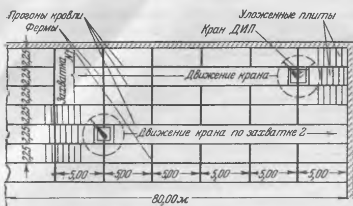
Рис. 2. Схема монтажа сборных железобетонных плит кровли с применением крана ДИП.
