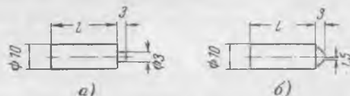
Рис. 2. Типы приваривавшихся шипов. а — с цилиндрической заточкой; б — с конической заточкой.
