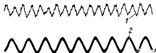
Рис. 3. Осциллограмма вибраций спинки статора гидрогенератора СВ-546/90-40 при холостом ходе.
