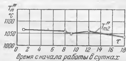
Рис. 4. Изменение температуры газов в конце второй камеры в течение кампании котла. Нагрузка D = 190\text{--}192 т/час.
