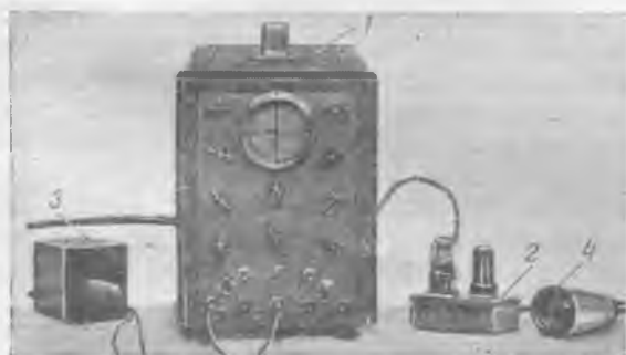
Рис. 1. Устройство для определения фазы вибрации.
