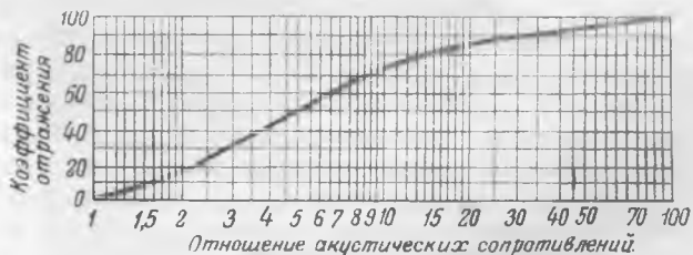
Рис. 1. График коэффициента отражения звука на границе раздела двух сред в зависимости от их акустических сопротивлений.
