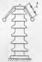
Рис. 2. Разрядные напряжения промышленной частоты разрядников РВП-35 в зависимости от положения кольца l .
