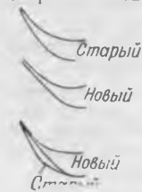
Рис. 4. Профили выходной части лопаток старого и нового роторов.
