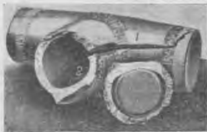
Рис. 2. Опытный тройник из углеродистой стали марки 20 после разрушения.
