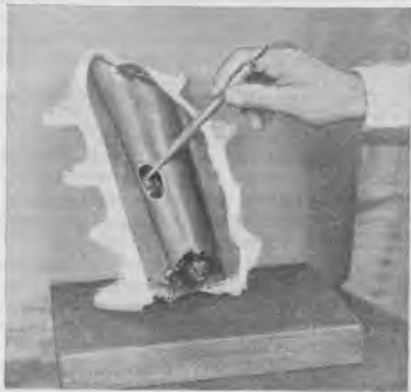
Рис. 1. Полость в заливочной массе ввода, образовавшаяся вследствие неправильной технологии заливки.
